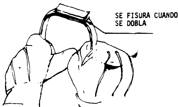
FIGURA 27.B. - DOBLADO DE LA PROBETA
